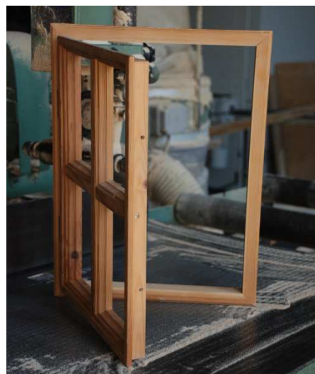
Esempi di serramenti con partitura non appropriata.
